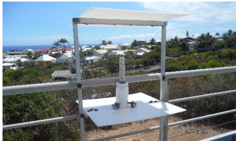
Figure III-21 : Mesure des embruns salins avec une mèche mouillée sur le site de Saint-Pierre à l'île de la Réunion.
