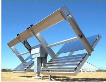
Figure II-8 : Un système EMMAQUA à Phoenix (Arizona). [68]
