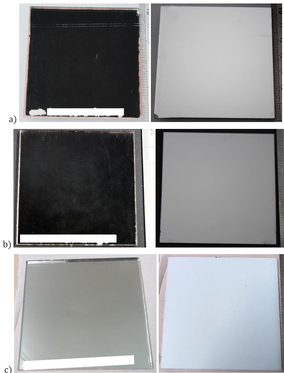
Figure IV-46 : Face avant et arrière du miroir B après a) 174 jours à PIMENT, b) 587 jours à INES et c) 581 jours à Cadarache.
