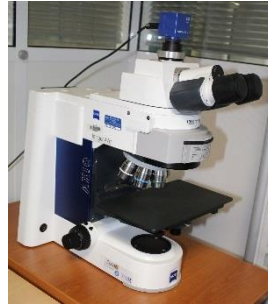
Figure III-7 : Microscope optique Zeiss Axio Imager A2m équipé d'une caméra Axio Cam.
