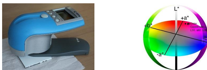
Figure III-6 : Colorimètre et espace de couleur CIE L^* a^* b^* .
