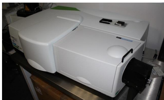
Figure III-4 : Spectrophotomètre Perkin-Elmer Lambda 950 avec sphère d'intégration.
