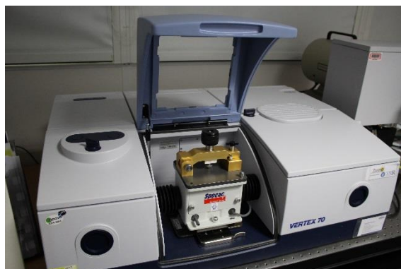
Figure III-5 : Spectromètre Bruker Vertex 70 équipé de l'accessoire ATR.
