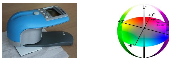
Figure III-6 : Colorimètre et espace de couleur CIE L^* a^* b^* .
