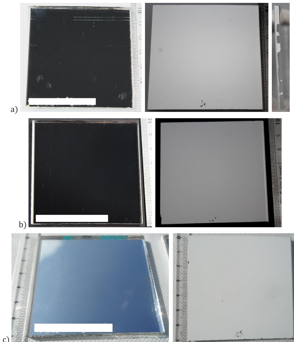
Figure IV-42 : Face avant et arrière du miroir A après a) 174 jours à PIMENT, b) 587 jours à INES et c) 581 jours à Cadarache.
