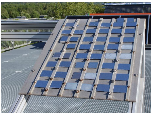
Figure III-18 : Ancien support d'échantillons utilisé à l'INES.
