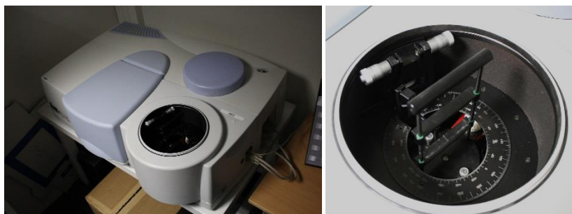
Figure III-2 : Spectrophotomètre Perkin-Elmer Lambda 950, équipé d'un ARTA et zoom sur la partie contenant le porte-échantillon et le détecteur.
