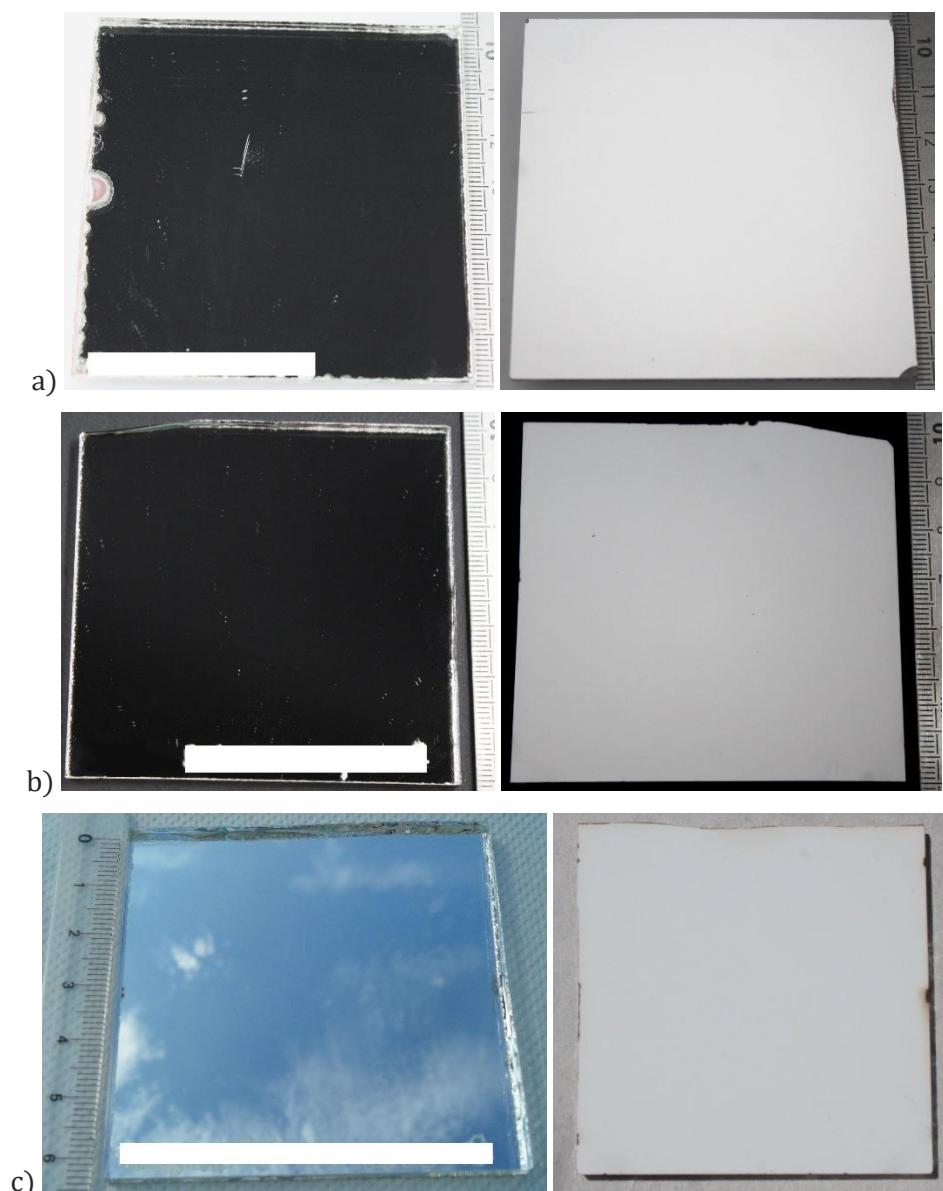
Figure IV-43 : Face avant et arrière du miroir C après a) 174 jours à PIMENT, b) 587 jours à INES et c) 581 jours à Cadarache.
