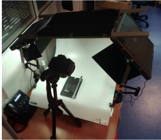
Figure III-1 : Banc de photographie des miroirs
