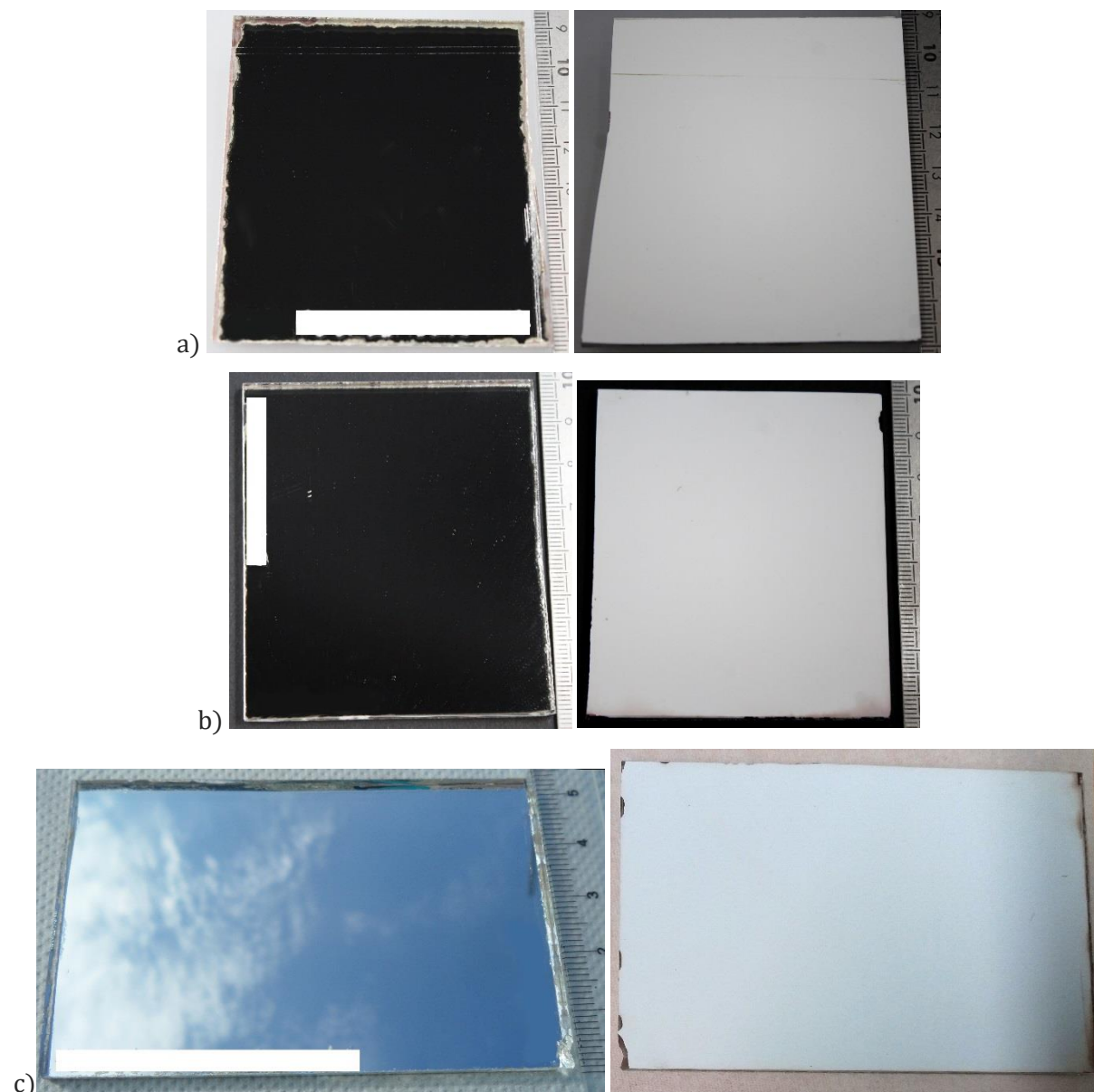
Figure IV-44 : Face avant et arrière du miroir D après a) 174 jours à PIMENT, b) 587 jours à INES et c) 581 jours à Cadarache.
