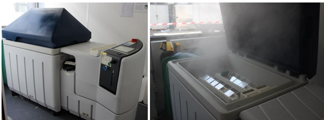
Enceinte de brouillard salin Weiss SC 450
