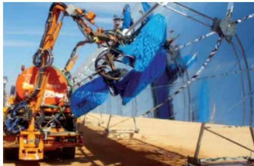
Figure II-13 : Nettoyage de miroirs cylindro-paraboliques avec un camion adapté à Ain Beni Mathar au Maroc. [1]
