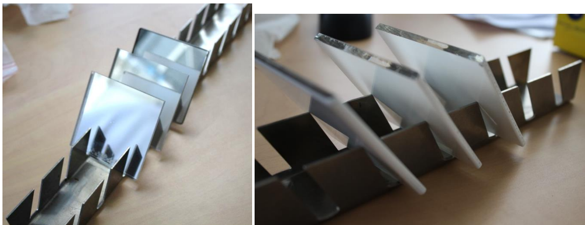
Support d'échantillons pour les essais en température et en chaleur humide
