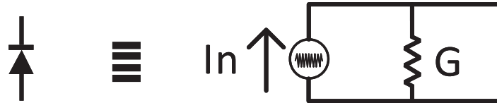
FIGURE I.5: Équivalence entre une jonction idéale et bruitée
