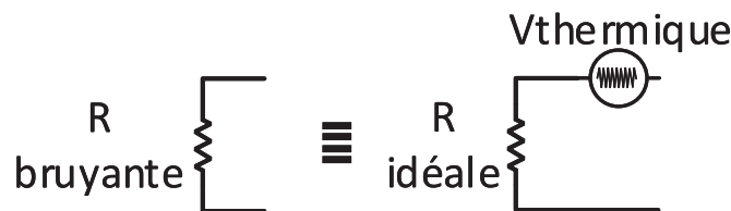
FIGURE I.4: Équivalence entre un résistance bruitée et idéale
