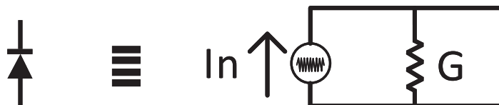
FIGURE I.5: Équivalence entre une jonction idéale et bruitée
