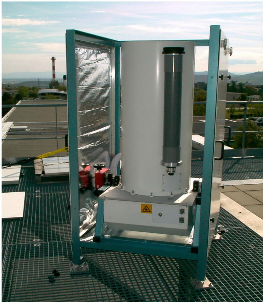
Figure 2.10. Partie optique du LIDAR Raman sur le site des Cézeaux.
