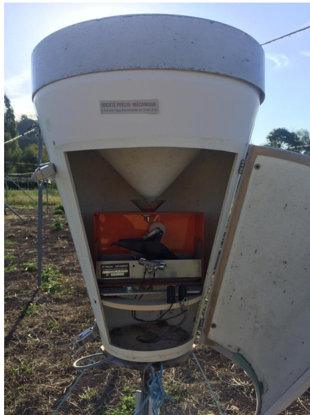
Figure 2.4. Pluviomètre à auget basculant de l'OPGC installé sur la station d'Opme. On peut voir l'auget et le tube de mercure qui est en dessous de l'auget, lorsque l'auget bascule, un contact électrique est établi et enregistré.
