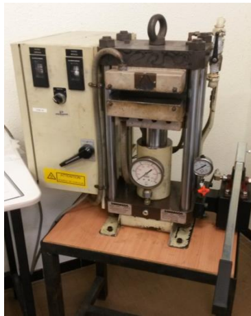
Figure 50 - Presse Darragon type Labo servant à la préparation des films fins.
