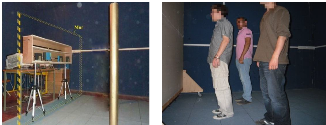
FIGURE 2.11 – photographie de la scène réelle de mesures pour le radar pulsé avec différents types de cibles (métalliques et humaines).
