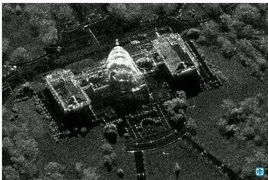
FIGURE 1 – Image SAR du Capitole dans la bande K_u - 15 GHz, Washington. (Copyright : Sandia National Laboratory).
