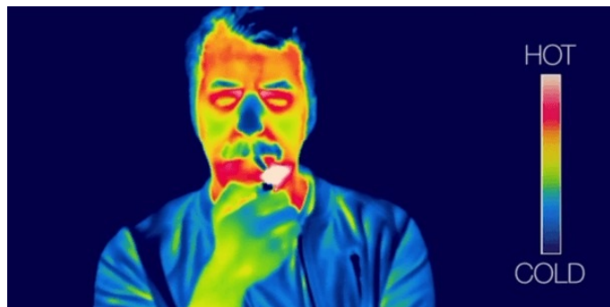
FIGURE 6 – Image thermique dans l'infrarouge moyen présentant une longueur d'onde supérieure aux images du spectre visible.
