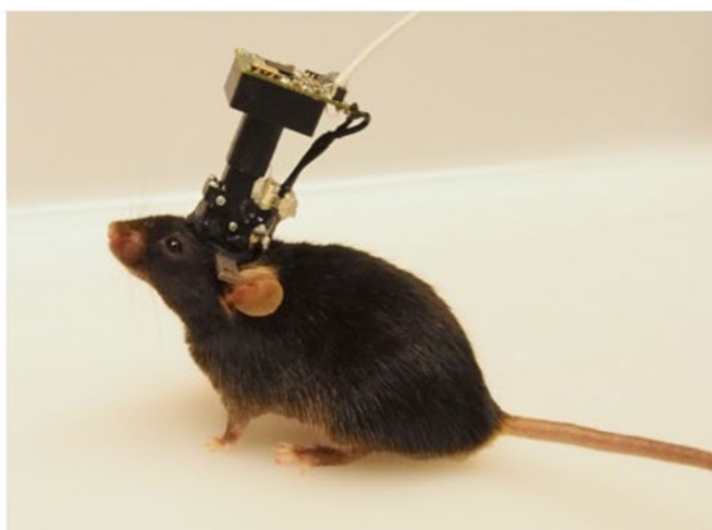
FIGURE 1.17 – Photographie d’une souris équipée d’un microscope plénoptique miniaturisé. Figure extraite de [70].
