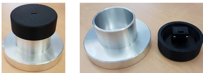
FIGURE 4.10 – Pot en aluminium et couvercle associé. Le couvercle dispose d'un bloc de maintien de la sonde. Une fois sécurisée dans ce bloc, la sonde peut être immergée dans la source liquide. Les dimensions ont été choisies de manière à placer les matrices de pixels des capteurs au centre du volume d'eau.
