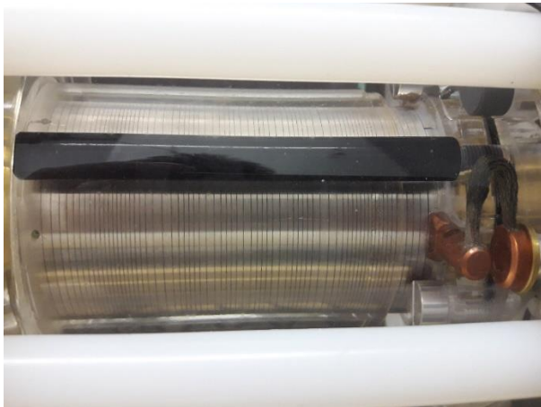
Figure 2-27 : Solénoïde externe en vue transversale avec ses enroulements de spires découpées dans le cylindre d'argent. Les spires sont de largeur variable et inégalement espacées le long du cylindre.
