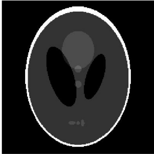
Figure 1-22 : (a) Image de référence représentant le fantôme à imager. (b) Image obtenue après reconstruction en présence d'un déplacement de champ magnétique oscillant à la fréquence de 1000 Hz et une amplitude de 100 Hz ( \approx 2 \mu\text{T} ) dont la phase est aléatoire répartie uniformément de -\pi à \pi d'une ligne de l'espace des k à l'autre. (c) Différence pixel à pixel entre l'image reconstruite et l'image de référence.
