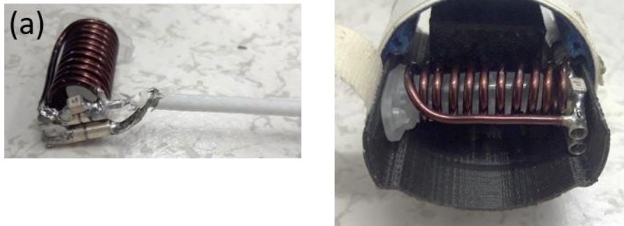
Figure 2-16 : (a) et (b) Antenne radiofréquence volumique de forme solénoïdale vue de côté. Le couplage est capacitif. Les capacités de « tuning » et « matching » sont réglables à l'extrémité du solénoïde. Le diamètre intérieur est de 8 mm. (b) Antenne avec tube à essai à l'intérieur placée dans son support de centrage vue de face.
