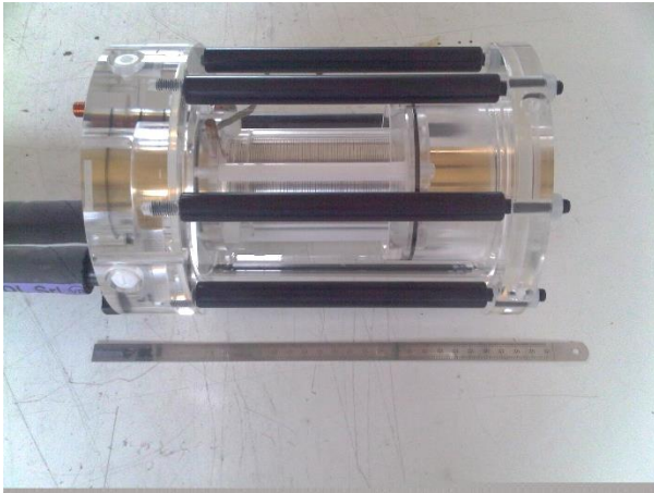
Figure 2-25 : Bobine résistive pour le champ cyclé en vue transversale. Le solénoïde en argent est à l'intérieur entouré par le fluide caloporteur.
