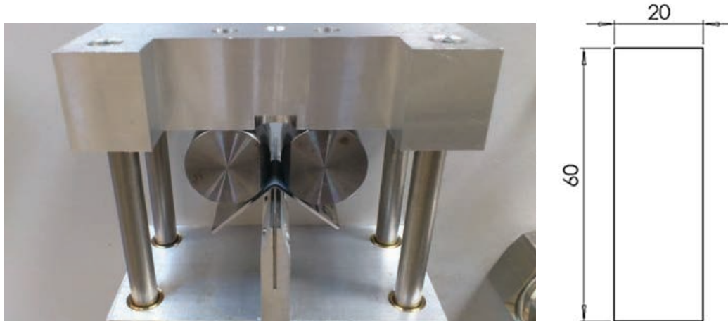
Figure 4.15 – Dispositif de V-bending et plan de l'éprouvette.
