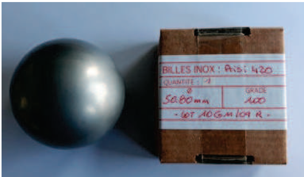
FIGURE 33 – La sphère étalon utilisée dans notre processus de validation. Elle a un diamètre de 50.80 mm (2 pouces).
