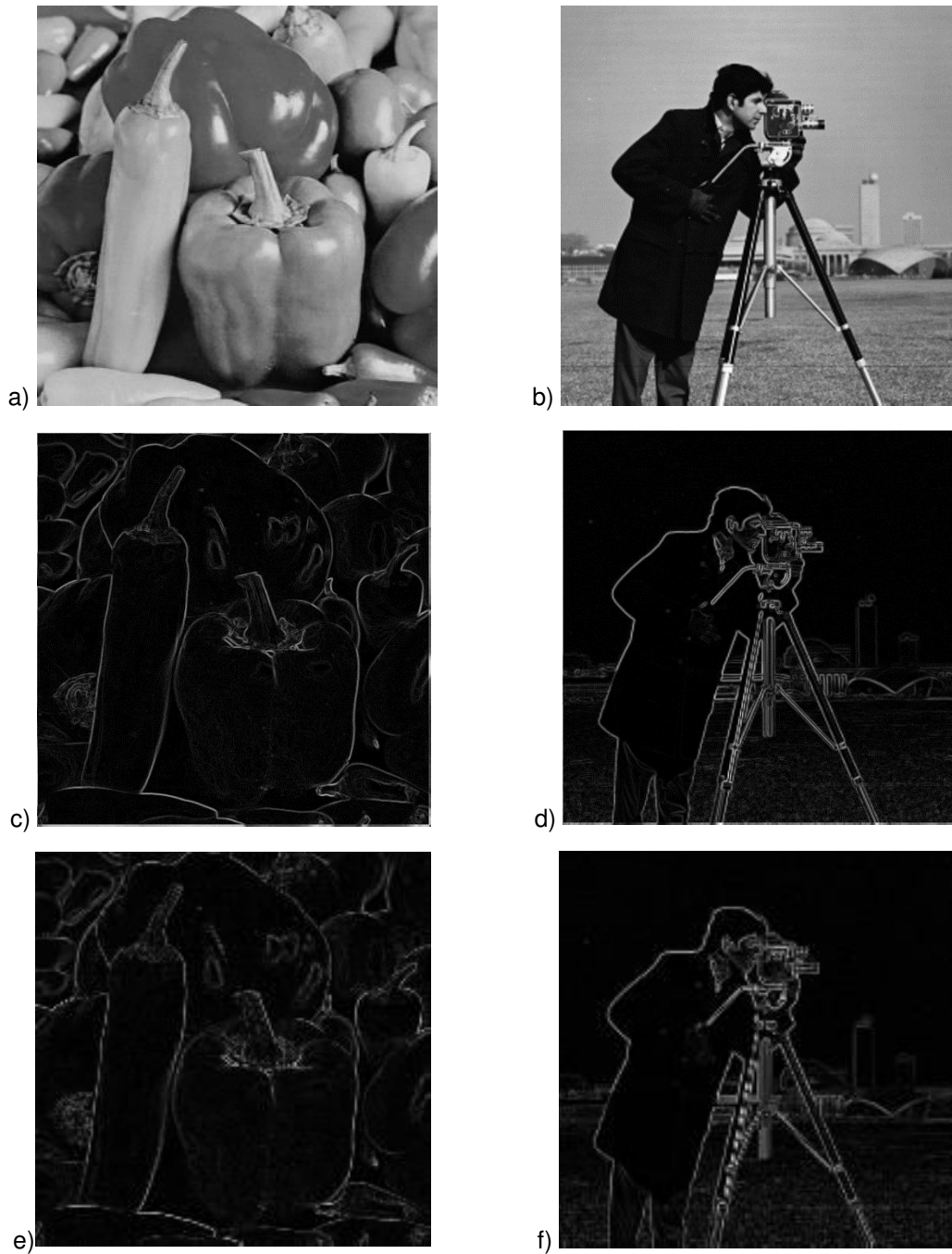
Figure 55 : Comparaison qualitative des différents prétraitements de contours : (a,b) images originales, (c,d) images traitées par l'algorithme de Sobel classique, (e,f) par Sobel sous-échantillonné. Toutes les images résultant de sous-échantillonnage ont 9 fois moins de pixels mais sont présentées ici à la même taille pour comparer les contours.
