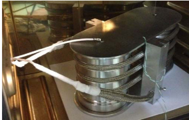
Figure II- 4: Câble sous vieillissement électrique
