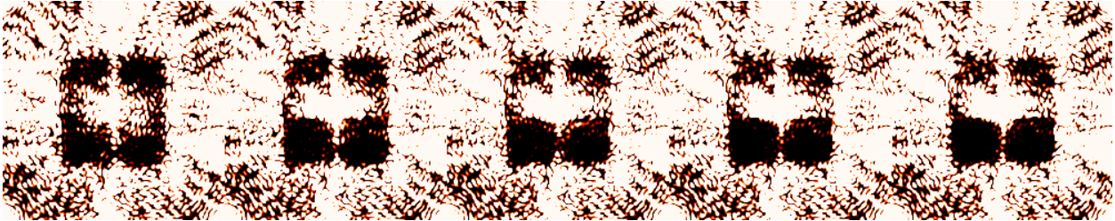
FIGURE 7.5 – De gauche à droite : image plan focal avant correction NLDH, après 1 correction, après 2 corrections, après 3 corrections, après 4 corrections. Échelle en arc de sinus hyperbolique, avec affichage volontairement saturé.
