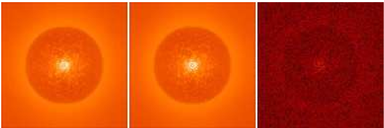
FIGURE 4.12 – À gauche : image focalisée utilisée comme donnée de COFFEE, comprenant une planète placée verticalement sous le centre, au tiers du rayon de la zone corrigée, avec un flux relatif à l'étoile de 10^{-5} . Au milieu : image synthétisée à partir de la phase estimée par COFFEE. À droite : différence entre l'image du milieu et l'image synthétisée à partir de la phase vraie : il n'y a pas d'impact de la planète, contrairement au cas de la figure 4.11.
