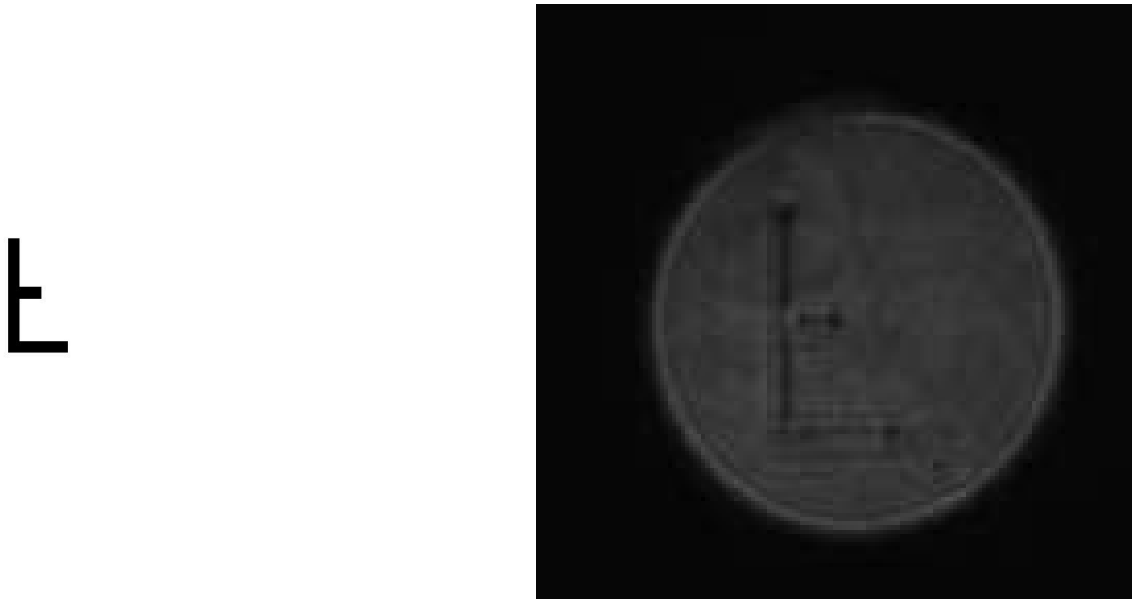
FIGURE 5.7 – Gauche : commande de phase en forme de F du modulateur spatial de lumière. Droite : imagerie de pupille correspondante.
