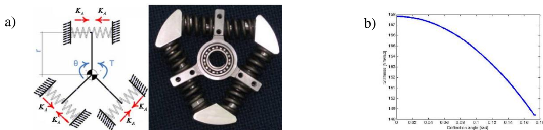
Figure I-7: a) le système ressort du CompAct b) sa caractéristique rigidité en fonction de déformation élastique [5].
