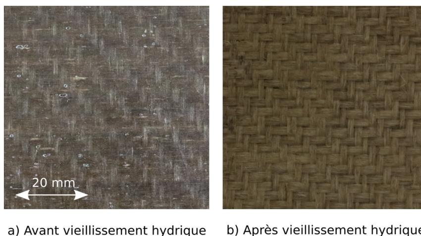
Figure 2.20 – Photographies d'un échantillon lin/époxy (a) avant et (b) après le vieillissement dans l'eau (H9)
