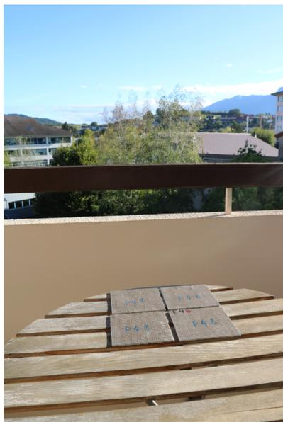
Figure 2.22 – Disposition des échantillons lors du vieillissement naturel
