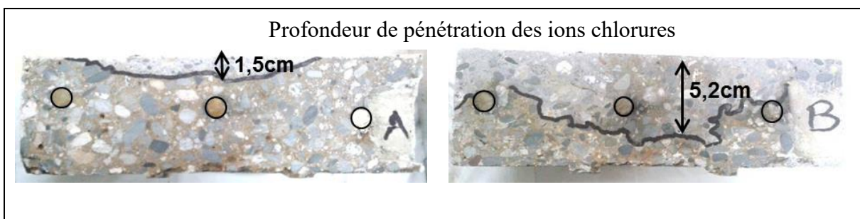
Figure III-11 : Photos des éprouvettes A (diffusion/absorption) et B (diffusion/absorption/migration) après l'essai de migration de chlorure, sciage et pulvérisation d'une solution d' \text{AgNO}_3 .
