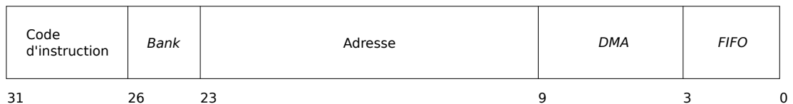
FIGURE 3.9 – Découpe d’une instruction du coprocesseur Ouessant.
