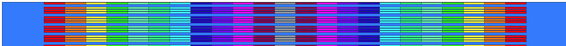
FIGURE 3.12: Configuration utilisée pour l'évolution axiale d'un assemblage (ici représenté horizontalement) composé de 19 crayons par côté et 25 tubes guides vides. L'assemblage est divisé en 13 univers évolutifs, chacun représenté par une couleur. Ces univers sont susceptibles d'occuper plusieurs places au sein de l'assemblage.
