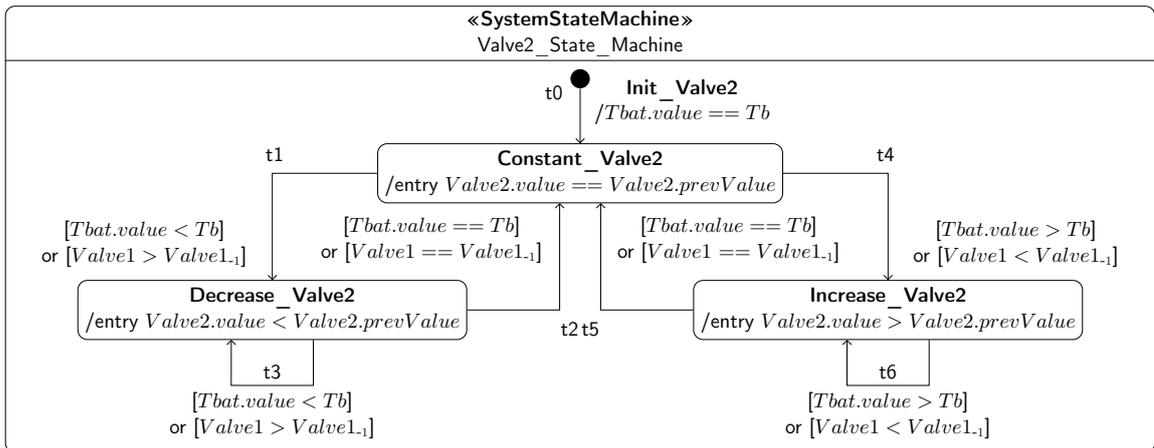
FIGURE 7.5 – Automate de régulation de la vanne Valve2
