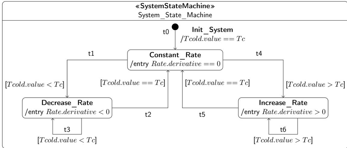
FIGURE 6.10 – Automate de régulation du système de refroidissement
