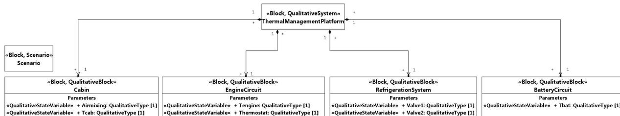
FIGURE 7.3 – Diagramme de définition de blocs de la plateforme de gestion thermique d'un véhicule hybride
