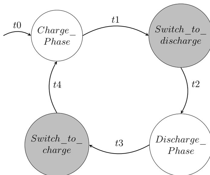
FIGURE 4.13 – Automate du circuit RC
