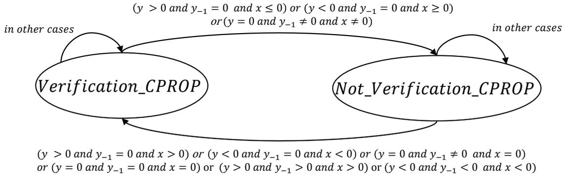
FIGURE 4.23 – Automate vérificateur de l'opérateur CPROP
