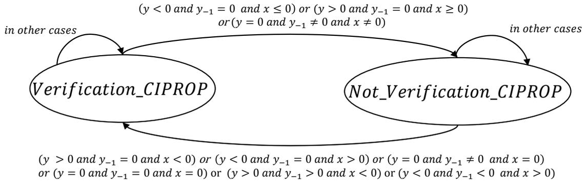
FIGURE 4.25 – Automate vérificateur de l'opérateur CIPROP
