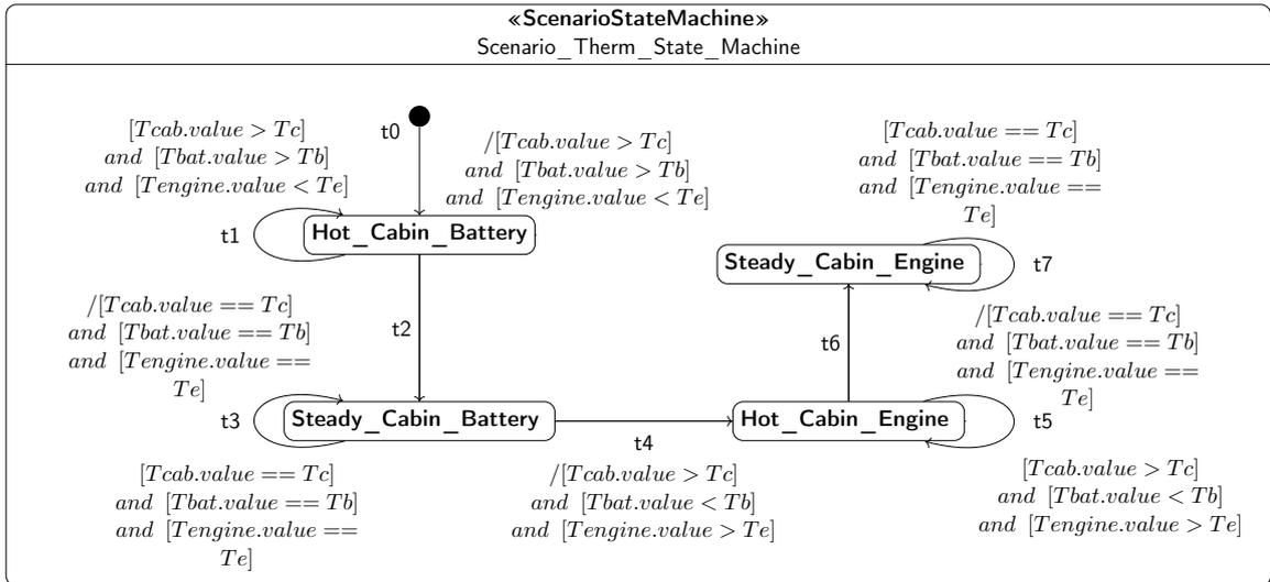
FIGURE 7.24 – Automate du scénario de simulation de la plateforme en mode hybride
