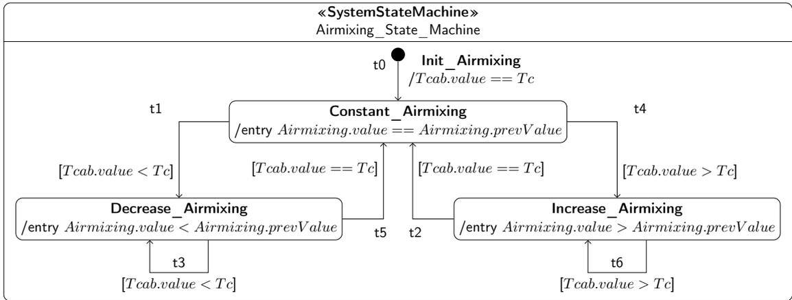
FIGURE 7.4 – Automate de régulation de Airmixing
