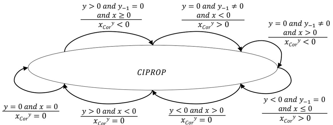
FIGURE 4.20 – Automate de l'opérateur qualitatif CIPROP
