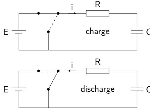
FIGURE 4.12 – Phases de charge et de décharge du condensateur du circuit RC
