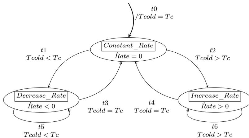
FIGURE 4.28 – Automate de régulation du système de refroidissement
