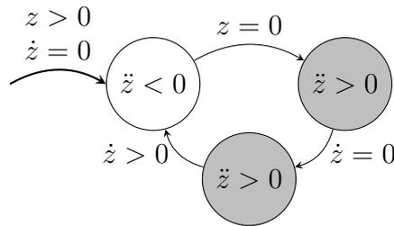
FIGURE 4.7 – Modèle de la balle rebondissante ajusté
