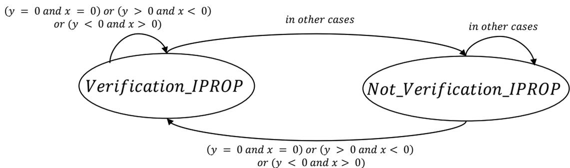
FIGURE 4.24 – Automate vérificateur de l'opérateur IPROP
