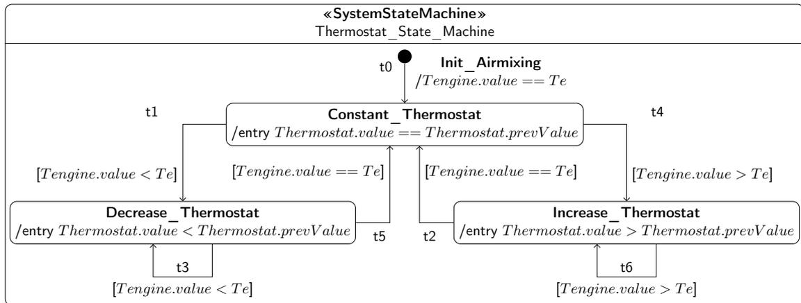
FIGURE 7.17 – Automate de régulation du Thermostat
