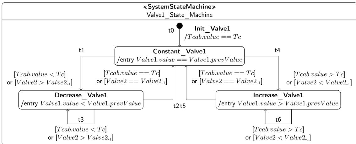
FIGURE 7.6 – Automate de régulation de la vanne Valve1
