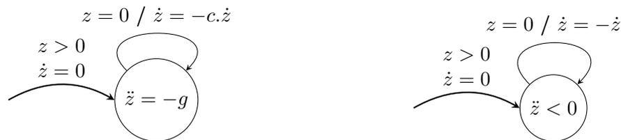
FIGURE 4.3 – Automates hybride (à gauche) et qualitatif (à droite) de la balle rebondissante
