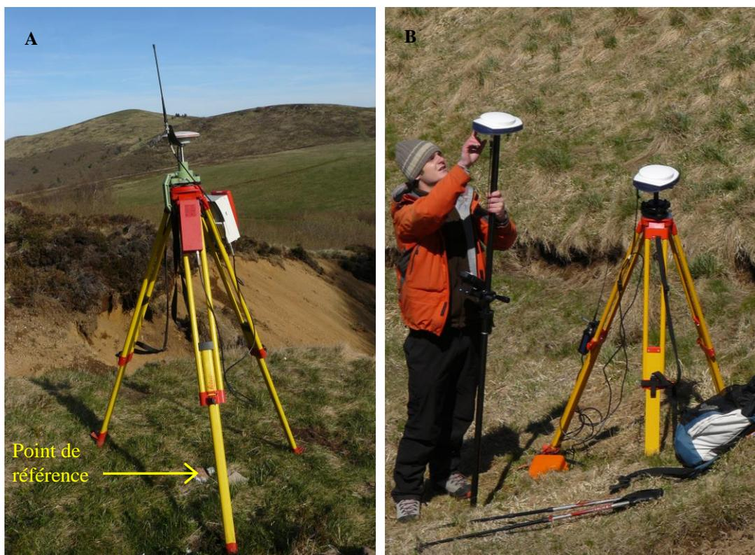
Fig. 42. GPS différentiel utilisé pour le suivi d'érosion. La photo A montre la base du DGPS Leica, la photo B le DGPS Magellan.
