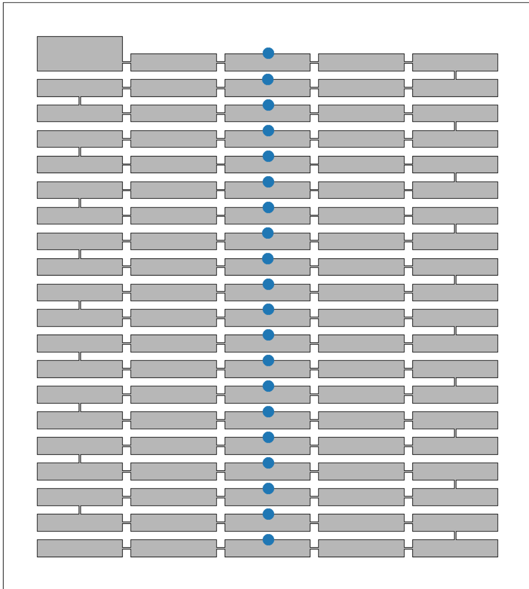
FIGURE 5.33 – Présentation du squelette du maillage 100 cellules reliées par un canal. La forme générale du réseau est celle d'un serpent. L'objectif est de permettre que le rendu visuel soit lisible, tout en préservant la connectivité des milieux. Les points bleus sont les points de mesure des tensions membranaires.
