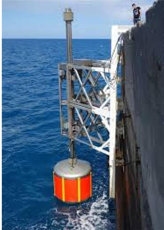
FIGURE 1.12 – Photo d’une bouée oscillante bord à quai développé par Sinn Power (source : Sinn Power)
