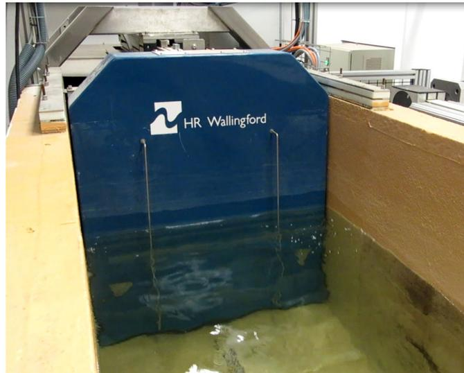
FIGURE 5.2 – Photo du batteur à l'extrémité du canal
