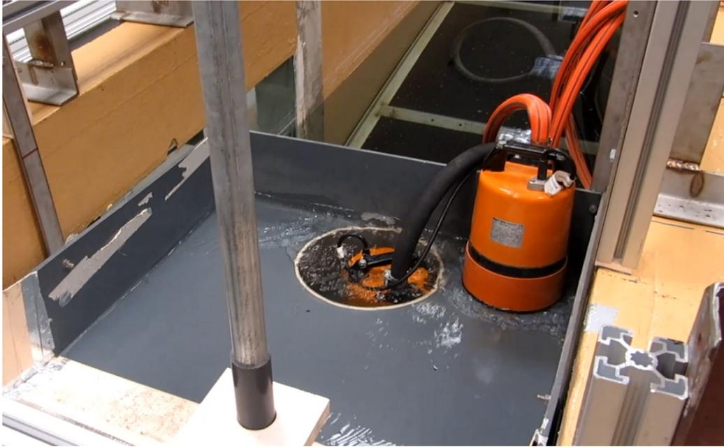
FIGURE 5.10 – Photo du bac de récupération et des pompes permettant la mesure des franchissements de houle
