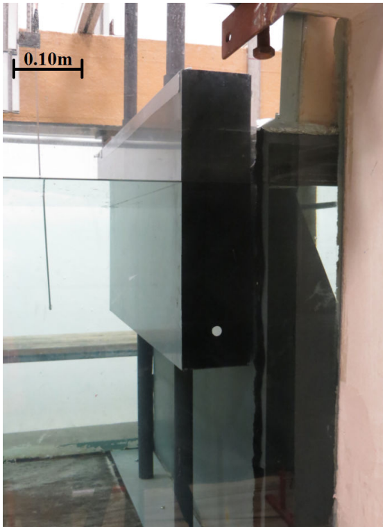
FIGURE 5.5 – Photo du flotteur 6, installé à proximité de la digue dans le canal
