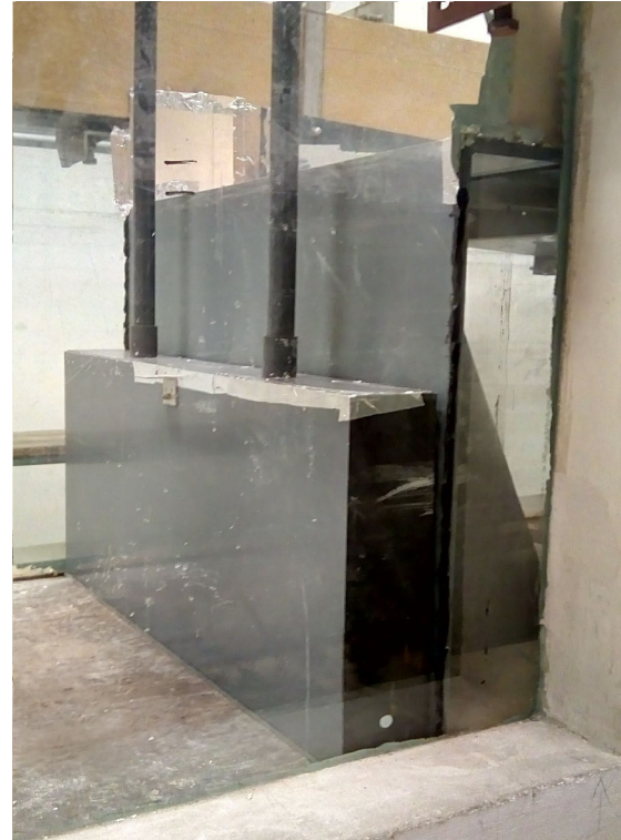
FIGURE 5.6 – Photo du flotteur 6, installé à proximité de la digue dans le canal (sans eau)
