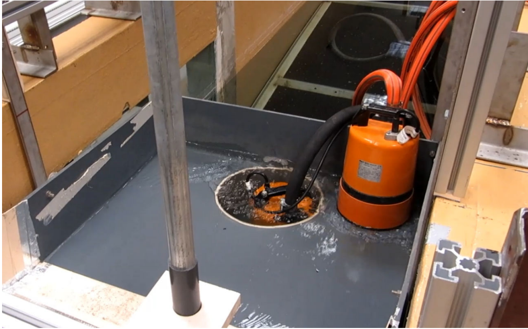
FIGURE 5.10 – Photo du bac de récupération et des pompes permettant la mesure des franchissements de houle
