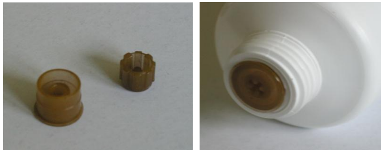
Embouts antimicrobiens injectés à partir de granulés EVOH modifiés avec des acétates de cuivre
