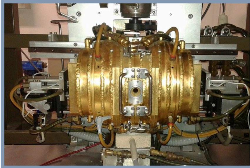
**Figure 34 | Four à image NEC**
