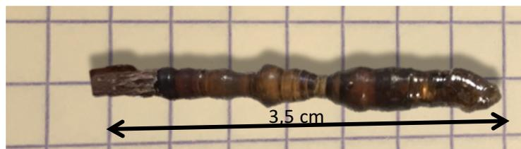
**Figure 51** | Cristal de  $\text{CaTiO}_3$  obtenu selon des conditions instables de croissance
