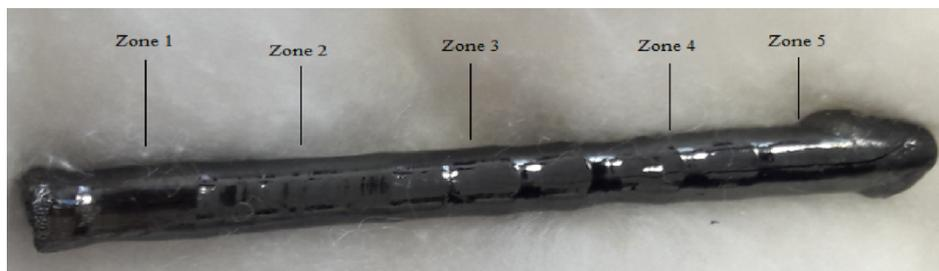
**Figure 65 | cristal de  $\text{BaTiO}_3$ .** Sans champ électrique aux zones 1, 3, 5 et sous champ électrique aux zones 2 et 4 sous air
