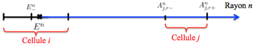
FIGURE 4.3 – Schéma du chemin optique d'un rayon n émis en E^n
