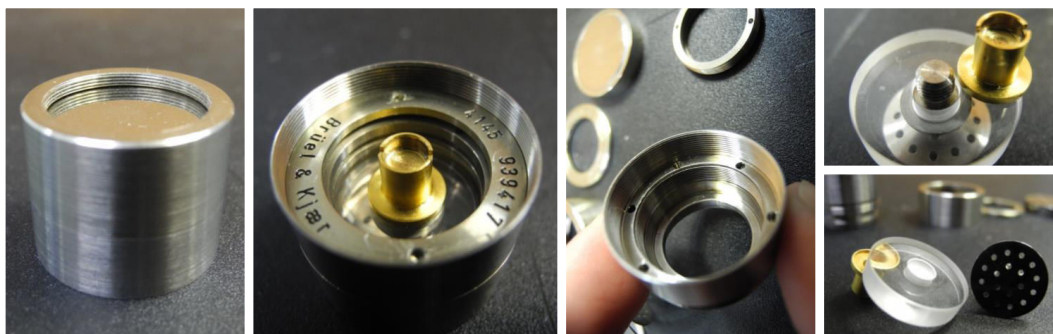
FIGURE C.1 – Photographies du démontage d'un microphone LS1p .
