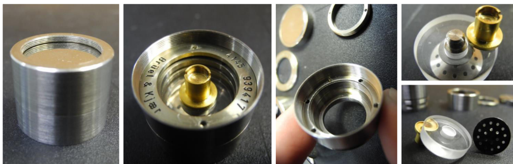
FIGURE C.1 – Photographies du démontage d'un microphone LS1p .
