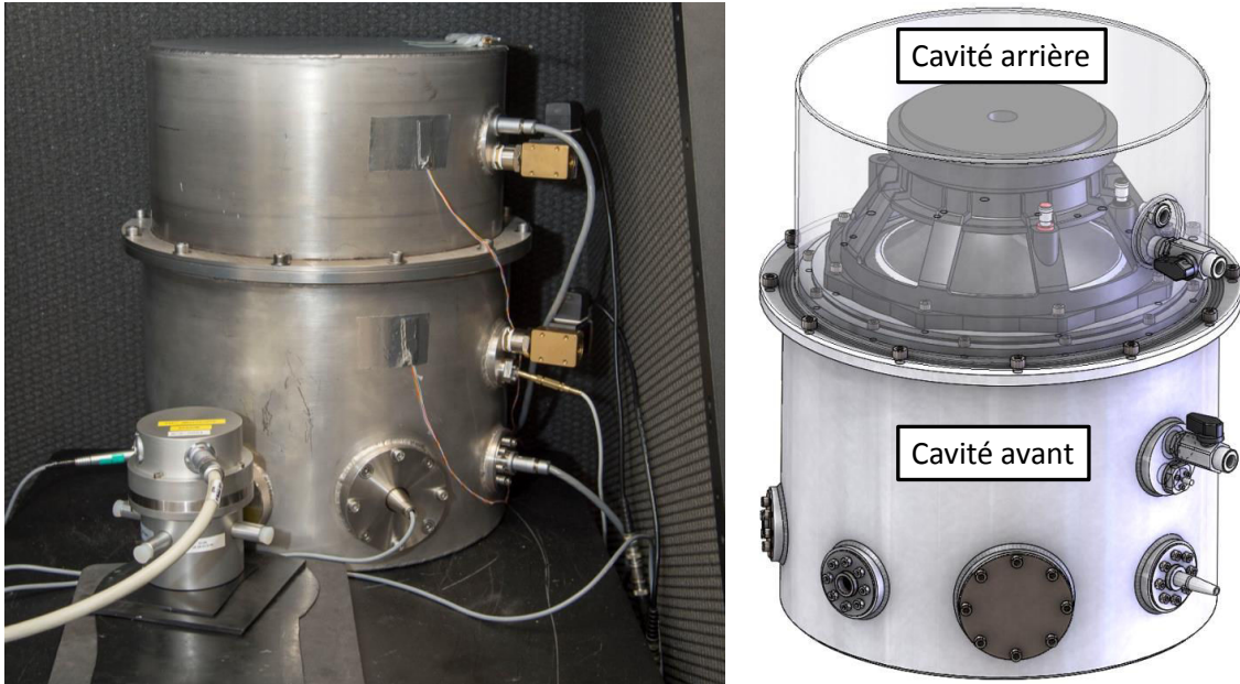
FIGURE 1.7 – Générateur de pression dynamique infrasonore du CEA.
