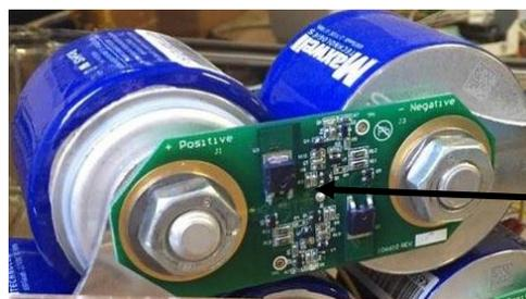
Circuit d'équilibrage pour les supercondensateurs
