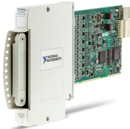
Figure G.3 : Carte d'acquisition de température PXI4353
