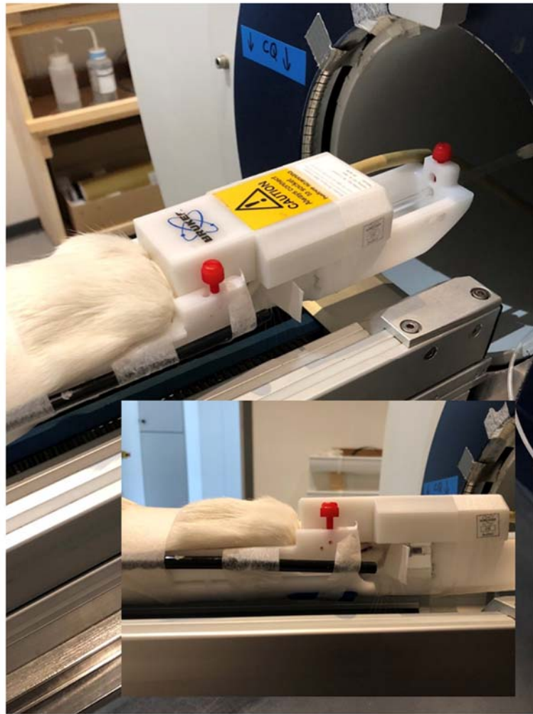
Figure 15 : Positionnement de l'antenne tête. La tête du rat est en position horizontale et bloquée par des barres d'oreille. Vérifiez que la voile se déplace librement et qu'elle n'est pas bloquée par l'antenne ou le lit d'IRM.
