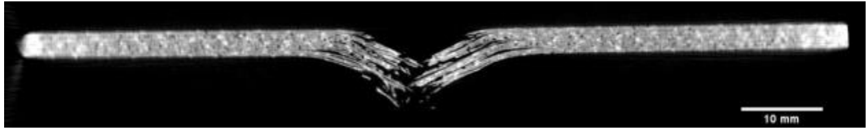
Figure 4-16. Image de tomographie RX d'une plaque fabriquée hors autoclave à partir du préimprégné B, impactée à 29 J.
