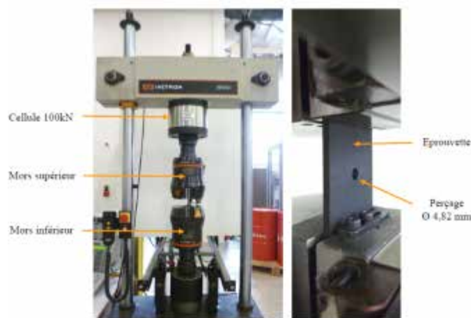
Figure 4-12. Photographie du montage réalisé pour les essais de Compression trouée.
