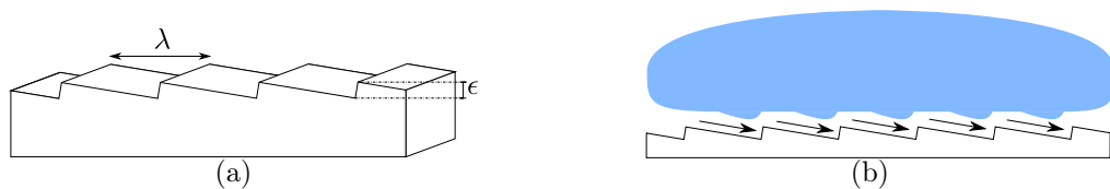
FIGURE 4.23 – (a) Schéma d’une surface en toit d’usine. (b) L’écoulement de vapeur sous la goutte est rectifié par l’asymétrie du substrat et entraîne par viscosité la goutte conformément aux visualisations établies [111].
