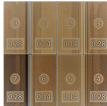
FIGURE 2.12 – Image brute du détecteur avec mise en évidence des octants et leur identification (dans un ovale) telle que spécifiée par le constructeur et leur bruit de lecture (dans un rectangle) en e - /px.
