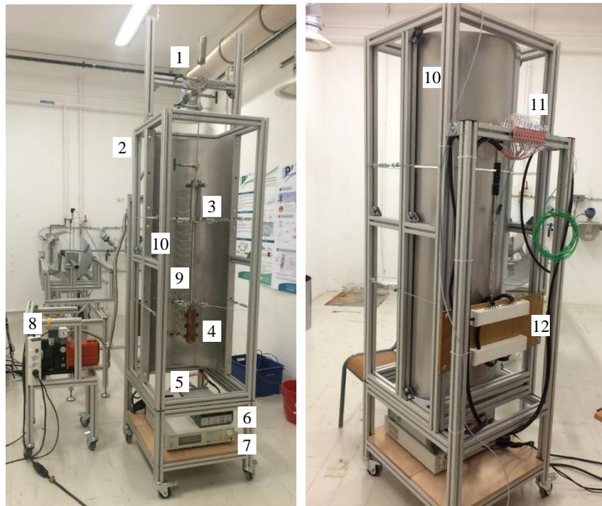
Figure 4-23: Vue de face du banc expérimental thermosiphon au naphthalène.
