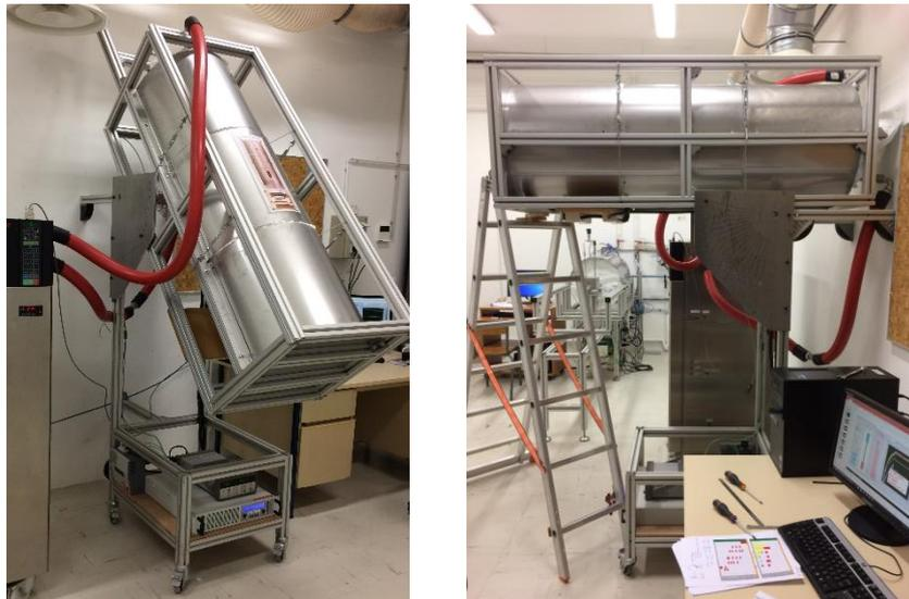
Figure 4-24: Vue du thermosiphon au naphthalène en position inclinée.
