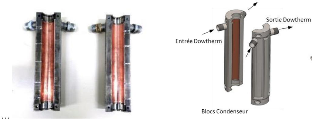
Figure 4-11: Blocs échangeur-condenseur opérationnels.
