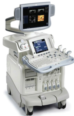
FIGURE 1.2 – Photographie d'un échographe pour application en imagerie médicale ultrasonore [2]
