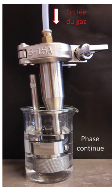
FIGURE 2.5 – Module de type microkit en acier inoxydable fourni par SPG Technology Co. Ltd
