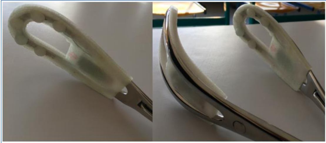
Figure 30 - Capteurs de pression en place sur le forceps
