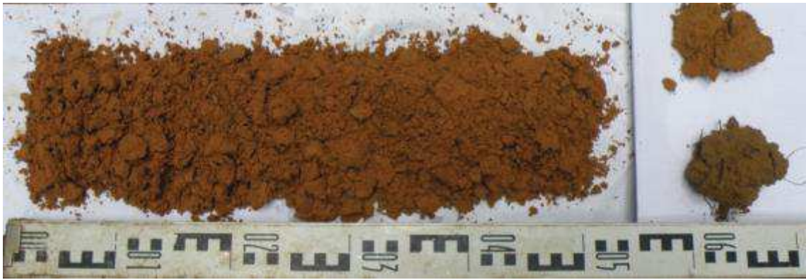
Photo 1-7 : sondage tarière entre 150 et 200 cm de profondeur - l'horizon 4 se poursuit - couleur graduellement plus rouge en comparaison avec les horizons 2 (en bas à droite) et 3 (en haut à droite)
