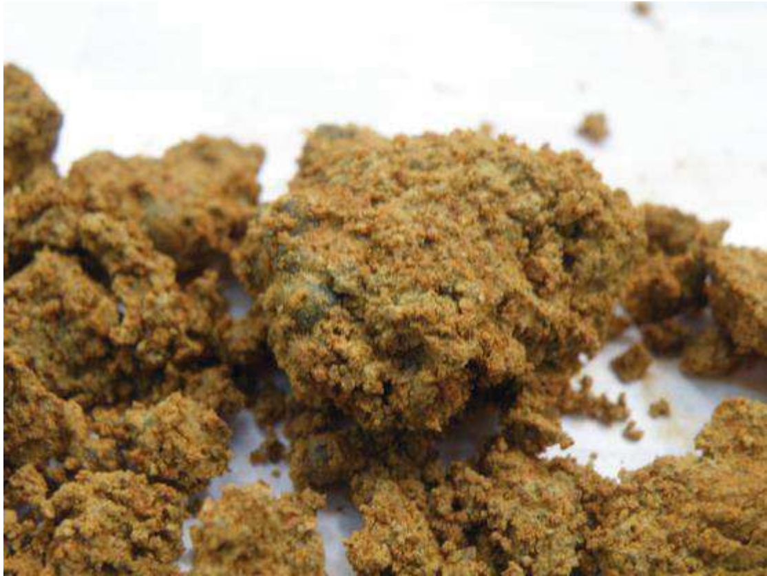
Photo 2-6 : horizon 3 avec nombreux pisolithes inclus dans la matrice - autres photos 232 à 238 et 274 à 283
