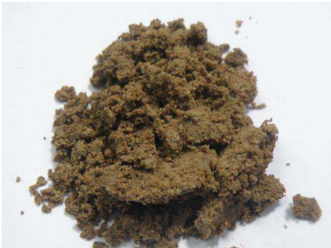
Photo 3-5 : horizon 2 avec tâches et structure polyédrique faible - autres photos 417 à 426
