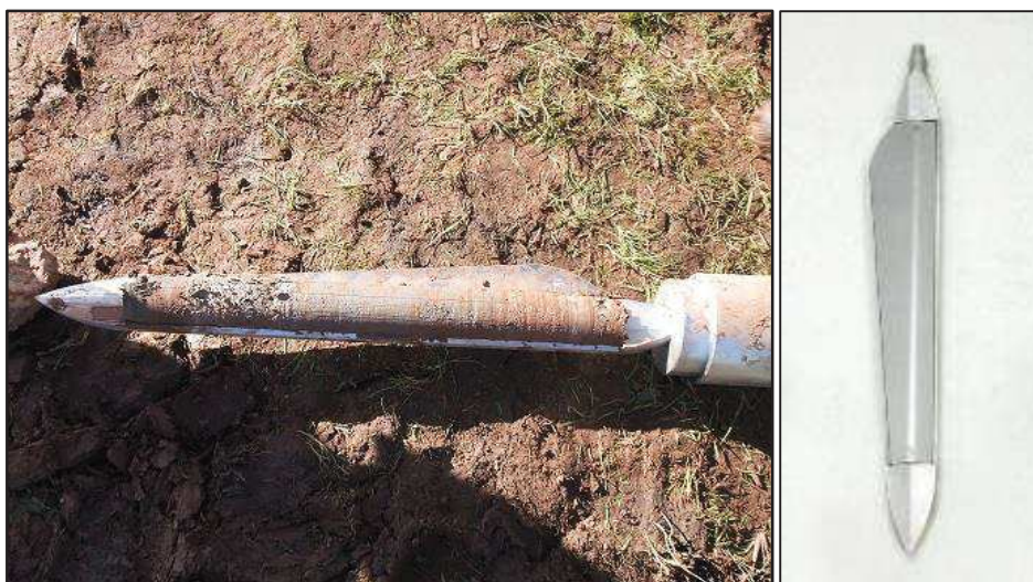
Figure 18: Carottier russe, avec une lame de 5 cm de diamètre.
