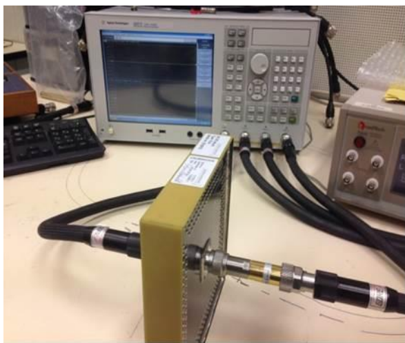
-a- Mesure du shunt coaxial de 10 A basé sur les résistances MELF
