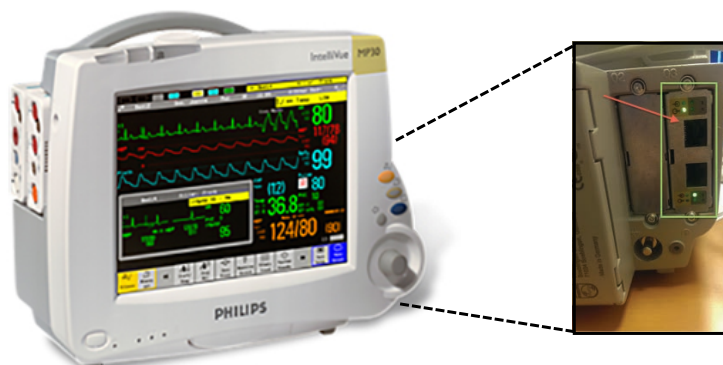
FIGURE 5.2: Image représentant conjointement un moniteur Philips IntelliVue MP30, couramment utilisé en clinique, et une carte d'export MIB/RS232 (cadre vert) équipant celui-ci. Via son port RJ45 (flèche rouge), elle permet une communication entre un client et le moniteur Philips.
