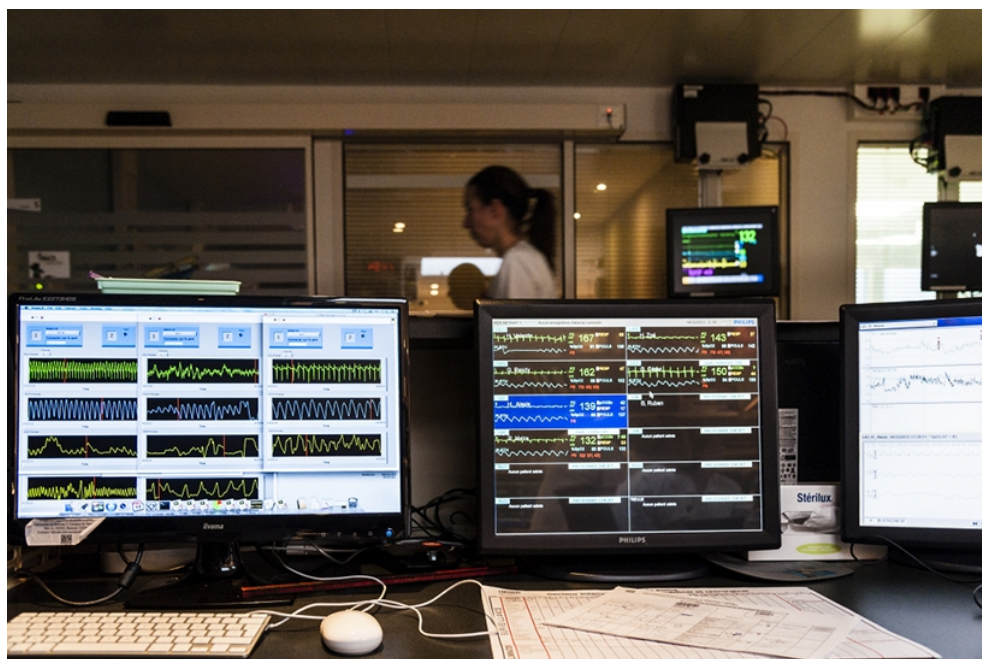
FIGURE 5.3: Photo capturée au sein du service de réanimation néonatale de l'hôpital Sud de Rennes [5]. L'écran à gauche présente l'application SYNAPSE en fonctionnement. Au centre, l'écran correspond à la centrale proposée par Philips, permettant d'afficher les signaux physiologiques de tous les moniteurs Philips IntelliVue de l'USIN sur un unique écran, mais sans possibilité de sauvegarde ni de traitement local. Au fond, les baies vitrées correspondent aux chambres des nouveau-nés.
