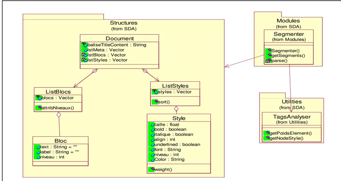
Figure 5.19 : Diagramme de classes du processus de segmentation
