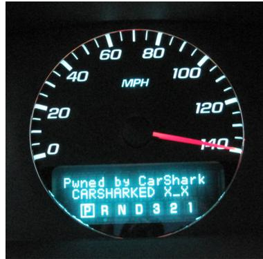
FIGURE 2.2 – Tableau de bord affichant une information vitesse erronée ainsi qu’un message personnalisé [KCR<sup>+</sup>10]
