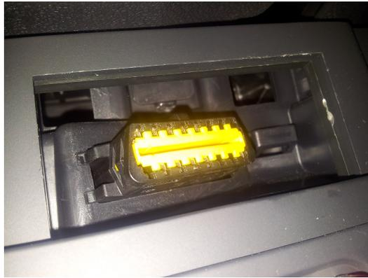
FIGURE 1.8 – Le port OBD d’une Renault Fluence
