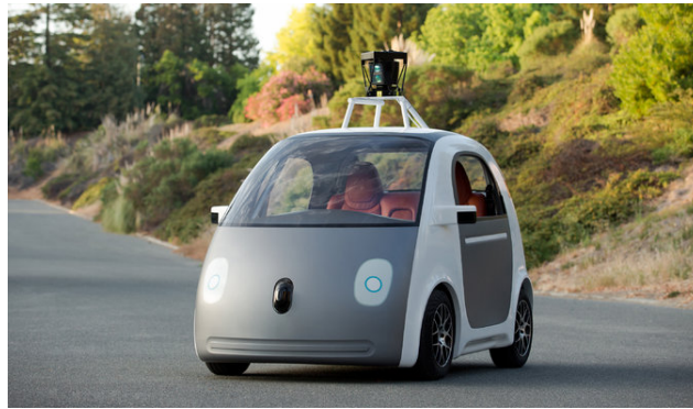
FIGURE 1.1 – Un prototype de véhicule autonome de Google
