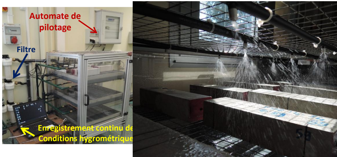
Figure 3: le dispositif ARIEL (simulAting RaInfall for concrEte durabiLity) pour corrosion accélérée par cycles de pluie en laboratoire
