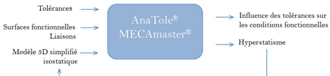
Figure I.13 – Entrées / Sorties des logiciels AnaTole et MECAmaster (Homri, 2014)
