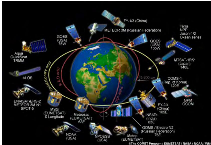
Figure 3.4: Quelques satellites différenciés par leur orbite géostationnaire (orbite jaune) et défilante (orbite rouge), www.eumetsat.int .
