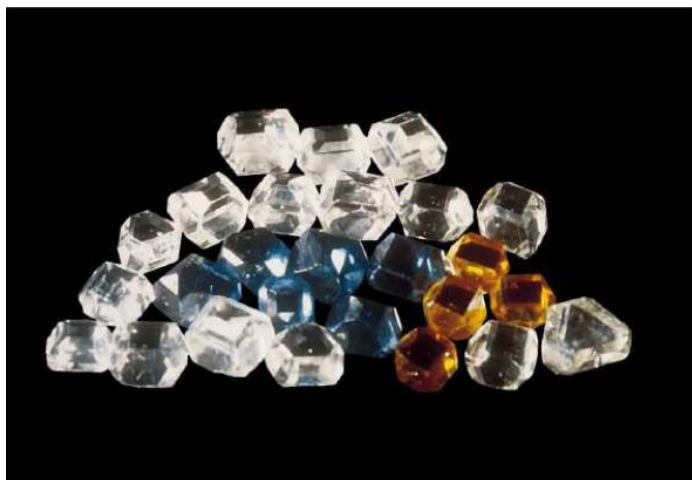
Figure 1.2 : Différents diamants synthétisés par la méthode HPHT [4] .
