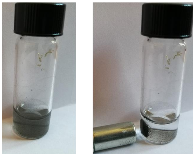
Figure 4.25 : Photo avant (gauche) et après (droite) la mise en contact avec les nanocomposites magnétiques en diamant nanocristallin avec un aimant.
